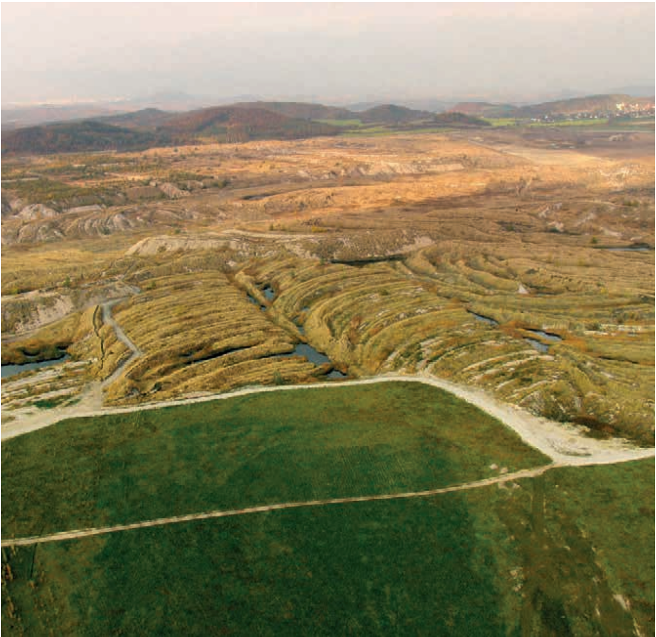
Obr. 6. Při technických rekultivacích je terén zarovnan, odvodněn a případně zúrodněn navezením ornice. Ve vrchní části obrázku z Radovesické výsypky je vidět prostředí vzniklé spontánní sukcesí, ve spodní výsledek technické rekultivace. (M. Hendrychová)
