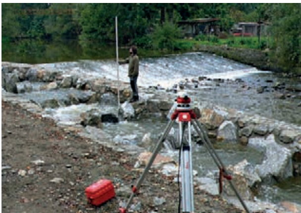
Obr. 7. Rybí přechod při jezu (v horní části úpravy) u starého zimního stadionu v zámeckém parku, který byl pojednán jako betonový žlab s příčnými řadami balvanů. Pracovníci AOPK ČR nivelují hladiny v tůních přechodu, aby mohli posoudit rovnoměrnost dělení spádu mezi jednotlivé příčné řady balvanů. (T. Just)
